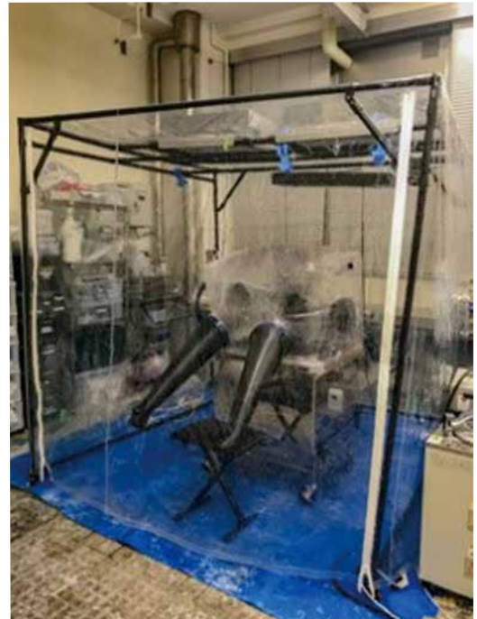
クリーンブース内に設置されたDPFブタ（無菌ブタ）飼育アイソレーター
